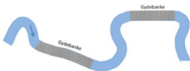
Figur 14: Placering af gydegrus imellem svingprofiler, fra vejledningen fra DTU Aqua "Sådan laver man en gydebanke for laksefisk.
